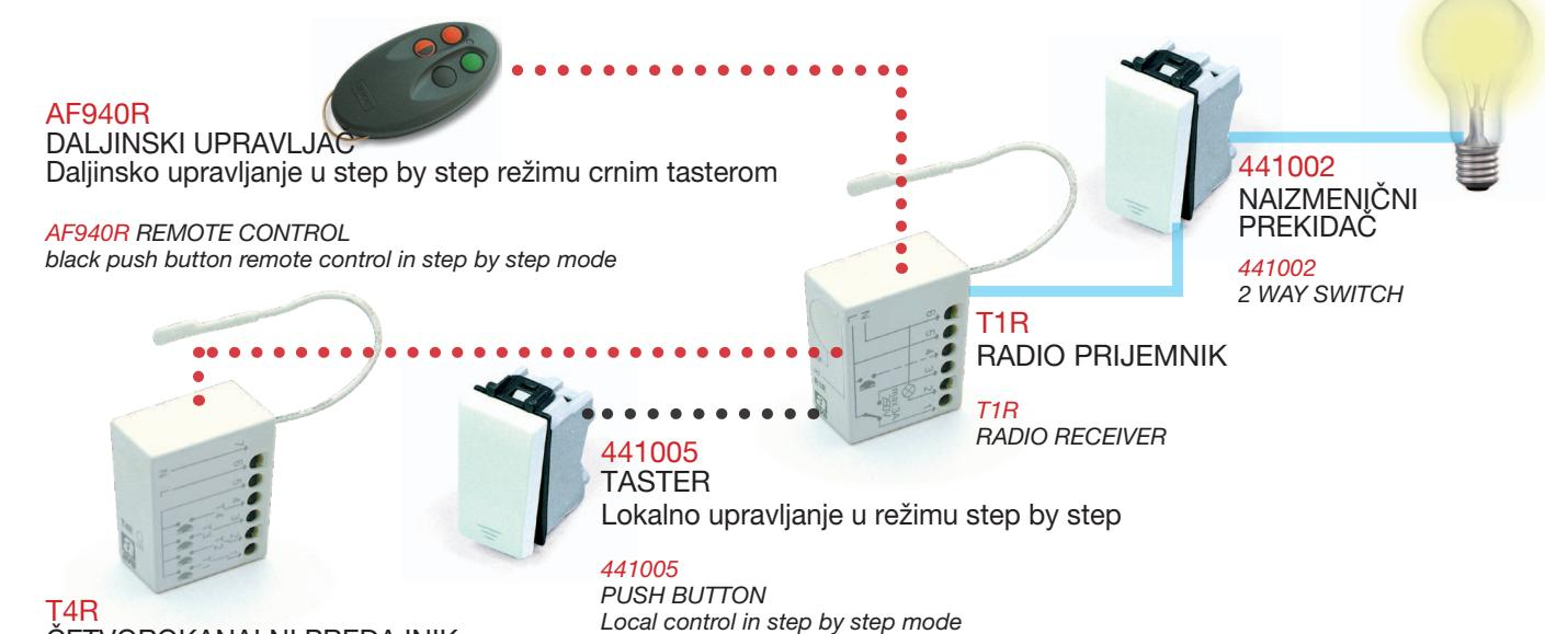
Prijemnik R1R komunicira sa svim predajnicima iz AVE-ovog programa, sistemima signalizacije provale, bežičnim IC detektorima prisustva i magnetnim kontaktima. Ovo omogućava ponavljanje alarme koji dolazi iz centrale ili od svakog pojedinačnog detektor-a po potrebi, na primer, kada se otvore vrata ili kada osoba zakorači u štićenu zonu.
