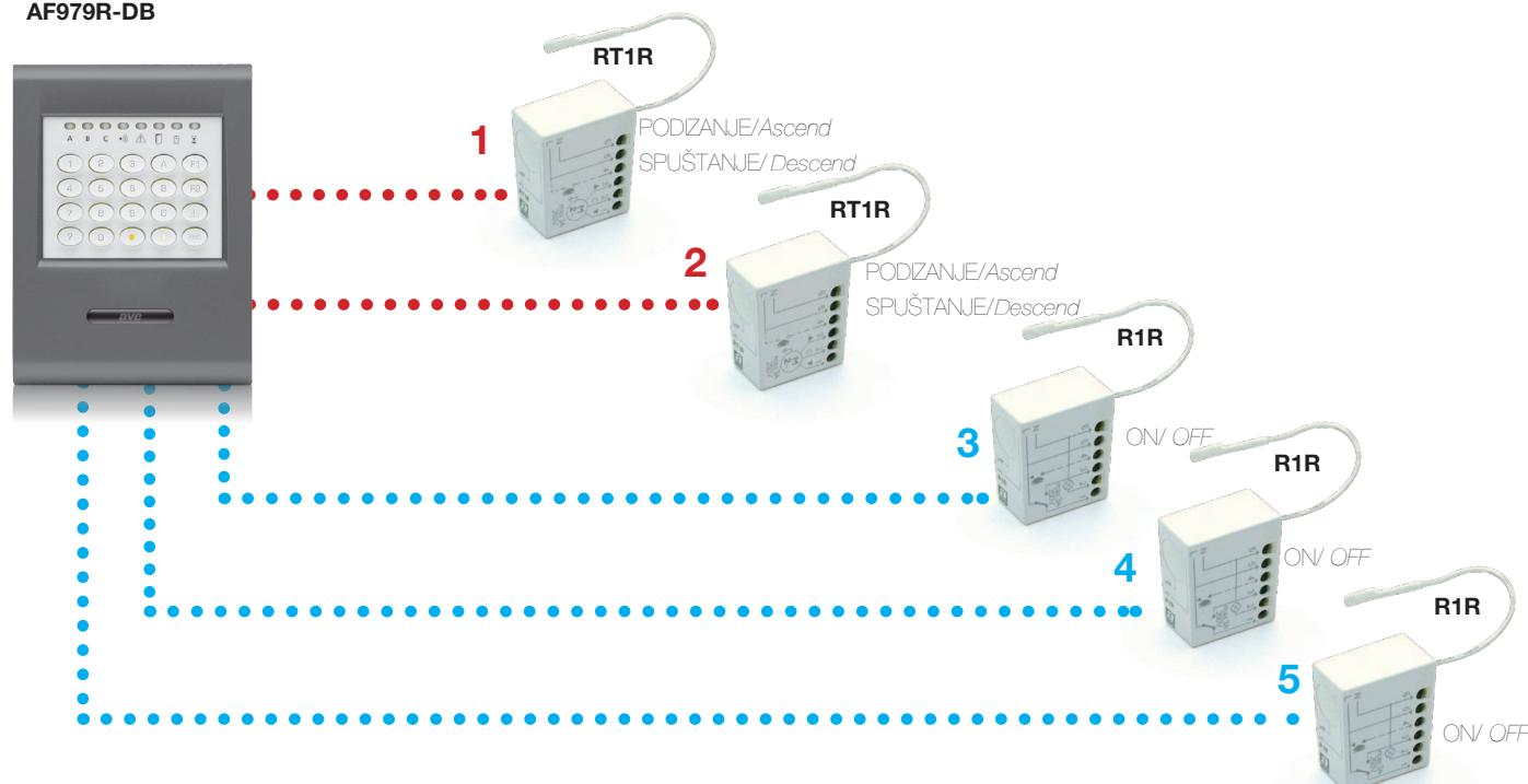
Zahvaljujući potpunoj integraciji prijemnika sa bežičnim (radio) sistemom provalne signalizacije, moguće je programirati sistem da spusti roletne kad je provalna centrala aktivirana sa ciljem da se omogući aktiviranje ovih funkcija istovremeno, jednom jednostavnom operacijom.
